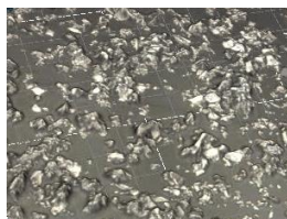
PERIO Tagatose粒子 レーザー顕微鏡（ \times 150 ）
